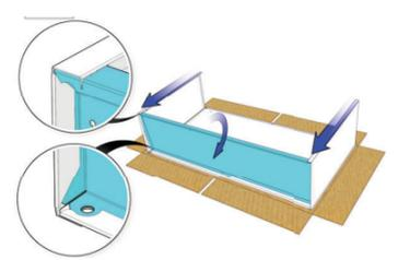
\* Com os dedos, empurre no local indicado para que a parte de cima encaixe e a parte de baixo se ajuste automaticamente. Repetir passo 02 para a montagem do fundo.
