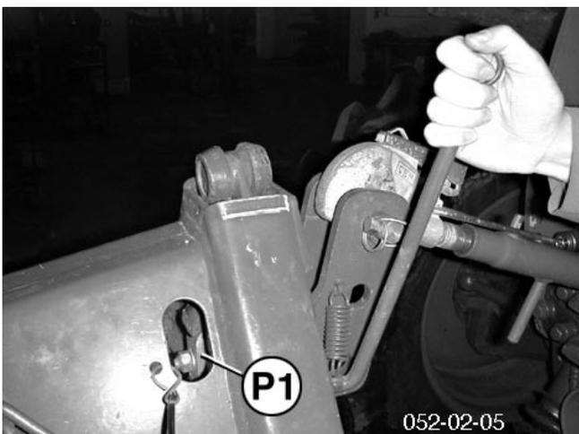
2. Montar o acoplador rápido (triângulo Weiste) na posição vertical ou ligeiramente inclinado para a frente no dispositivo de elevação frontal.
