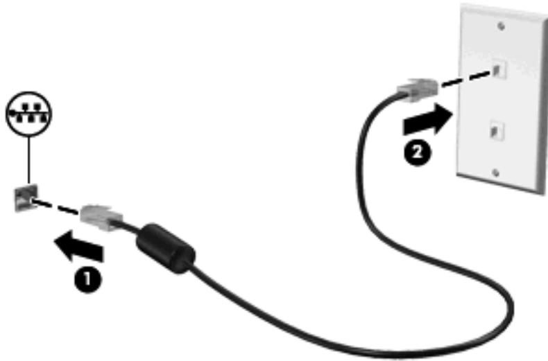
**⚠ AVISO!** Para reduzir o risco de choque elétrico, incêndio ou danos ao equipamento, não conecte um cabo de modem ou de telefone a conectores RJ-45 (rede).
