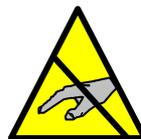
Os cartões eletrônicos do equipamento podem possuir componentes sensíveis a descargas eletrostáticas. Não toque diretamente sobre componentes ou conectores. Caso necessário, toque antes na carcaça metálica aterrada ou utilize pulseira de aterramento adequada.
