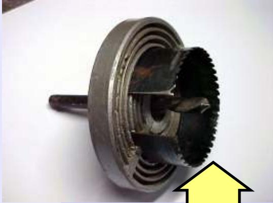
Serra copo de 44mm de diâmetro por 17mm de altura no máximo com broca de 6mm no centro.
