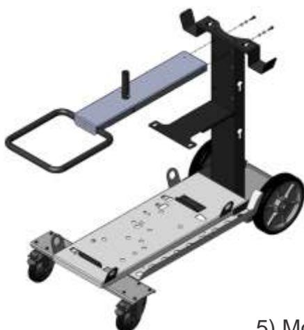
4) Montar o suporte de fixação da Fonte no suporte de apoio do Alimentador de Arame.
