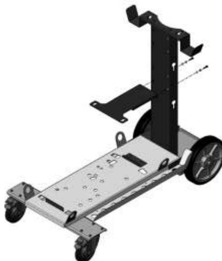
3) Montar o suporte de apoio do Alimentador de Arame.
