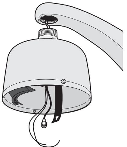
**Figura 6.** Encaixe da back box pendente no suporte
