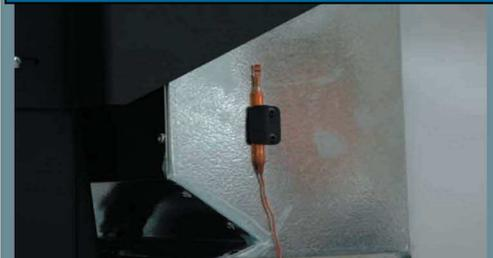
Quando, por motivos de uma falha no ventilador de ar de convexão que por sua vez provoca um sobreaquecimento do funil de enchimento, o termóstato é accionado e este por sua vez desliga o sem fim impulsor da entrada das peletes.
