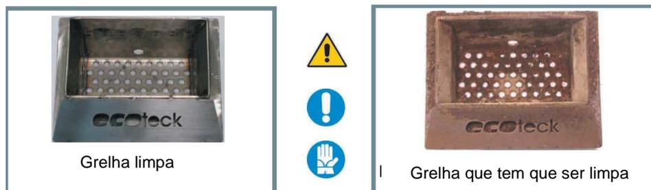
Só uma grelha que esteja em condições e limpa pode garantir um funcionamento sem problemas da salamandra a peletes. Depois de se formarem sedimentações na grelha, por vezes durante a queima do combustível, estas têm de ser imediatamente retiradas.
