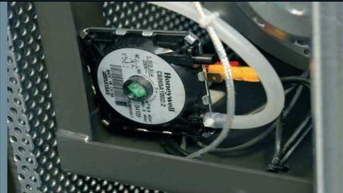
Este mede o vácuo correcto (escoamento) da chaminé; no caso de ter havido problemas com o escoamento do fumo ou sujidades das condutas de escoamento do gás, o monitor de supressão é accionado e desliga o sem fim impulsor da entrada das peletes.
