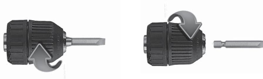
Fig. 1 – INSTALAÇÃO DA BROCA
