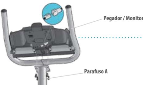
De forma lenta e cuidadosa, gire o monitor no sentido indicado pela seta até fazer coincidir a furação das abraçadeiras e do pegador. Para fixar o monitor use os quatro parafusos "B", utilize chave Philips (não acompanha o produto). Aperte os demais parafusos.
