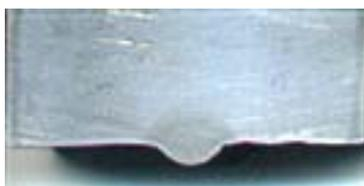
Figura 5.20 - Seção transversal do cordão em escala natural, realizado durante o ensaio 6.
