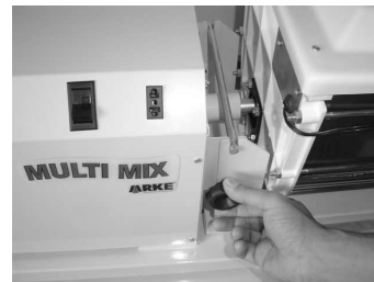
FIG. 3 e) - Através do orifício existente na parte superior da tampa, acrescente os ingredientes dentro do misturador tendo o cuidado de colocar primeiro os ingredientes sólidos e após os líquidos.
