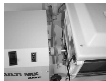
FIG. 2 b) - Posicionar a haste de fixação ( fig.02 ) e aperte os manípulos laterais ( fig.03 ).
