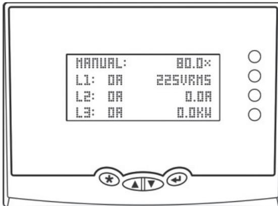
Na ativação da partida suave, na falta de rede, na inicialização/finalização do armazenamento de dados em pen drive, na troca do modo de operação, na ultrapassagem da porcentagem de comando do limite de comando ou do limite para economia de energia, no acionamento do bloqueio externo ou no acionamento do relé OUT1, o display exibe uma mensagem específica para a respectiva função na linha superior.
