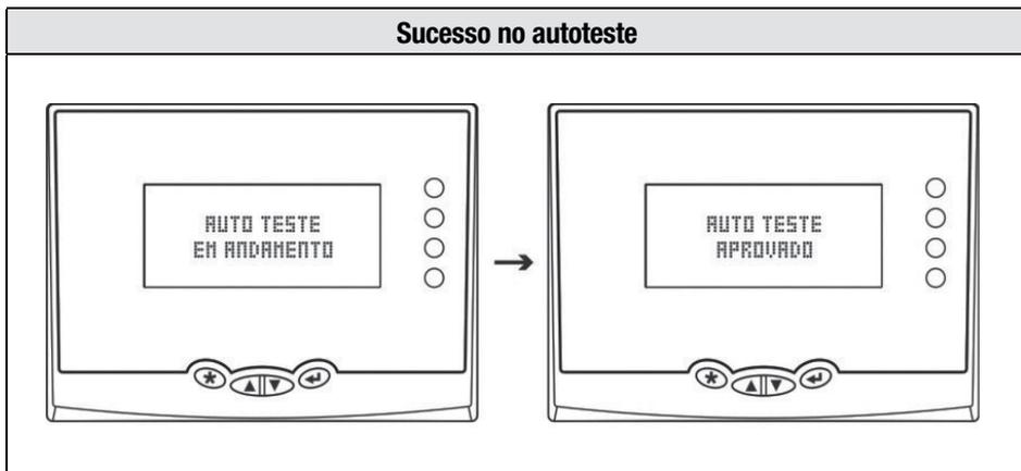
Em caso de falha com a alimentação, controlador ou carga, o autoteste é interrompido, a mensagem de falha é exibida e o display começa a piscar.
