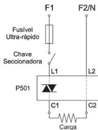
Nos modelos com uma fase controlada acima de 250A, ligar a fase controlada no barramento de entrada, e a fase de referência no borne L2, como destacado na figura abaixo.
