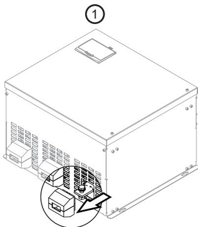
**2)** Desmontar o protetor, o separando em duas metades.
