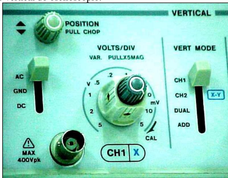
**Figura 3:** Botões de controle de varredura vertical do osciloscópio Minipa MO-1221S
