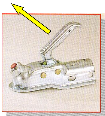
Figura 32: Exemplo de cabeça de ligação
