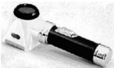
Amplificador Iluminado com lente de boa definição com 02 escalas removíveis, sistema métrico e inglês, e lentes para o exame preciso de impressões digitais e outras evidências. Diâmetro das lente 3,17cm. Inclui baterias.
