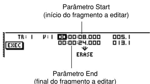
Pode-se ajustar os parâmetros Start/End em formato de contagem (o valor à esquerda) ou unidades de tempo/compasso (o valor à direita). Deslocar o cursor até ao dígito que desejar alterar e rodar o sintonizador [DATA/JOG] para ajustar o valor.
