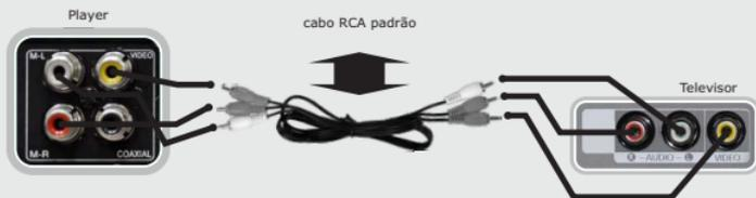
faça coincidir as cores do plug com as cores das saídas e entradas.
