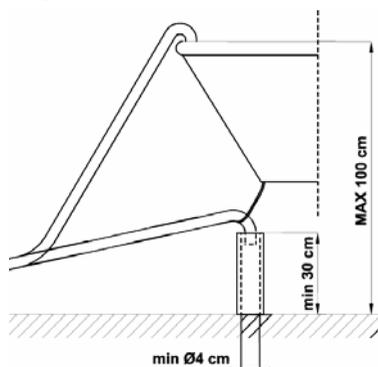
A extremidade livre deverá ficar colocada em um altura compreendida entre **30 e 100 cm** e não deverá nunca ficar imersa na água. Quando existirem mangueiras com extensões dispostas horizontalmente, num máximo de 3 m, posicionar a mangueira de escoamento a uma altura máxima de **85 cm** do chão.
