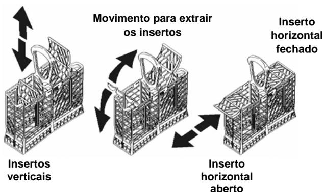
Além disso, é possível separá-lo em duas partes. Esta solução demonstra-se muito útil para a lavagem com  $\frac{1}{2}$  carga (nos modelos que possuem esta função).
