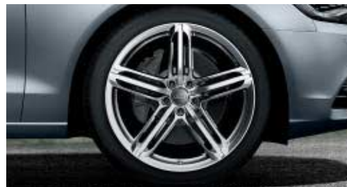
Jantes de alumínio fundido Audi exclusive com design de 5 raios em segmento Tamanho 8,5 J x 20 com pneus 255/35 R 20. Uma proposta da quattro GmbH.
