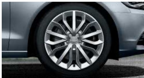
Jantes de alumínio fundido com design de 15 raios Tamanho 8,5 J x 19 com pneus 255/40 R 19; opcionalmente, com pneus run-flat.
