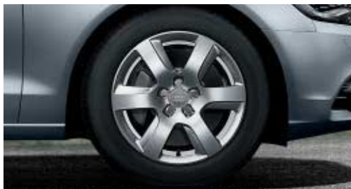
Jantes em alumínio ultra-leve forjado com design de 6 raios Tamanho 8 J x 17 com pneus 225/55 R 17.
