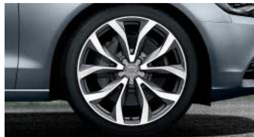
Jantes em alumínio ultra-leve forjado com design de 10 raios Antracite, parcialmente polidas, tamanho 8,5 J x 20 com pneus 255/35 R 20.
