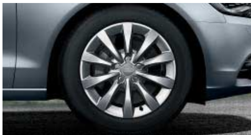
Jantes de alumínio fundido com design de 10 raios Tamanho 8 J x 17 com pneus 225/55 R 17; opcionalmente, com pneus All-Season.
