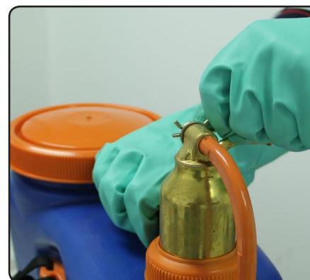
2 - Retire o pino de fixação e a haste de açãoamento da câmara.
