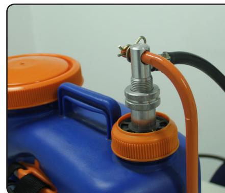
6 - Fixe a haste de acionamento da câmara no kit Dosador. Fixe uma das extremidades da mangueira no bico do Dosador. Na outra extremidade será montada a nova lanza.
