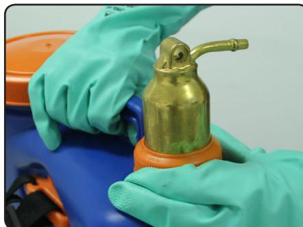
4 - Coloque o Dosador no local da câmara. O mexedor deverá ser encaixado no dispositivo plástico do dosador antes que o êmbolo seja encaixado no cilindro.
