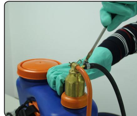
1 - Com o equipamento limpo, lavado e drenado, solte a abraçadeira de fixação da mangueira na câmara e retire-a.
