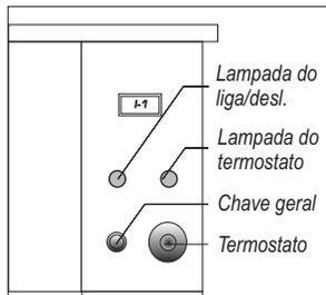
Acione a chave geral, gire o dial do termostato até a indicação da temperatura escolhida; quando a lâmpada apagar significa que o óleo atingiu a temperatura escolhida.
