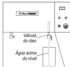
Quando fritar alimentos que produzam resíduos em excesso (farinha dos salgadinhos em geral), deve-se proceder com regularidade a sangria do óleo - retirada do excesso de água. Para este procedimento, abra um pouco a válvula do óleo e deixe escorrer o excesso de água da cuba. Quando o óleo começar a sair feche a válvula e volte a operar normalmente.
