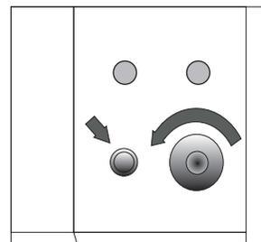
Quando desejar desligar o equipamento, gire o termostato no sentido anti-horário até a posição 0°C e desligue a chave geral.
