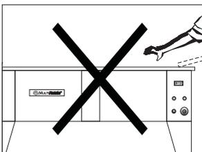
Nunca coloque os dedos no interior da cuba ou em contato com o óleo quando o equipamento estiver ligado.
