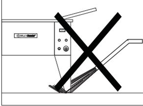
Ao limpar o local onde estiver instalado o equipamento, evite jatos d'água para não molhar as partes elétricas de seu interior, procurando protegê-las da umidade.
