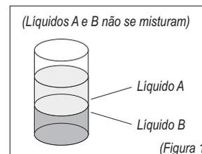
Este sistema, baseado na diferença de densidade de dois líquidos que não se misturam e na lei da gravidade, é fundamental para evitar a contaminação do óleo com sabores dos alimentos fritos no mesmo (fig. 1).
