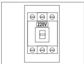
Certifique-se de que no circuito em que a máquina está ligada existe um disjuntor termoeletrico de proteção, dimensionado de acordo com a carga do mesmo e instalado próximo do equipamento.
