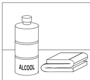
Quanto à parte externa, utilize um pano macio embebido em álcool. Evite a utilização de palha de aço ou scotch brite, que danificam o equipamento.
