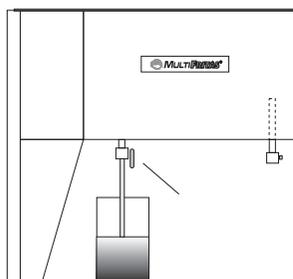
Coloque um recipiente sob a saída da válvula da água, abra a mesma e retire toda a água com os resíduos, efetuando posteriormente a limpeza da cuba com água quente e sabão ou detergente neutro.
