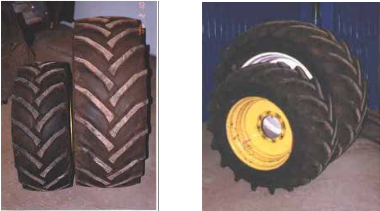
Figura 10. Vista frontal (à esquerda) e vista lateral (à direita) do pneu BPAF-1 (dianteiro) e BPAF-2 (traseiro) utilizados nos ensaios do equipamento.
