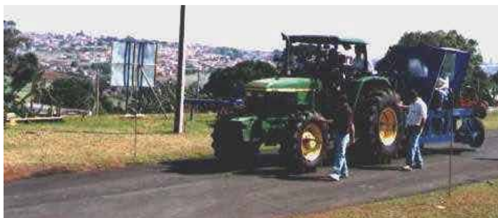
Figura 65. Ensaio piloto em superfície rígida com pneu BPAF-1
