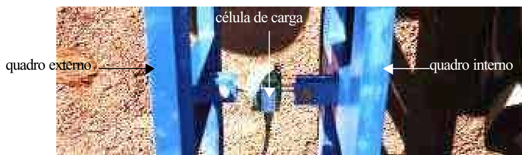
Figura 32. Localização da célula de carga de 50 kN entre os quadros interno e externo
