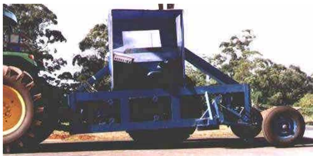
Figura 43. Posição abaixada com parte do peso no hidráulico do trator, no pneu individual e nas rodas de suspensão traseira, utilizada no controle da carga vertical durante o ensaio.
