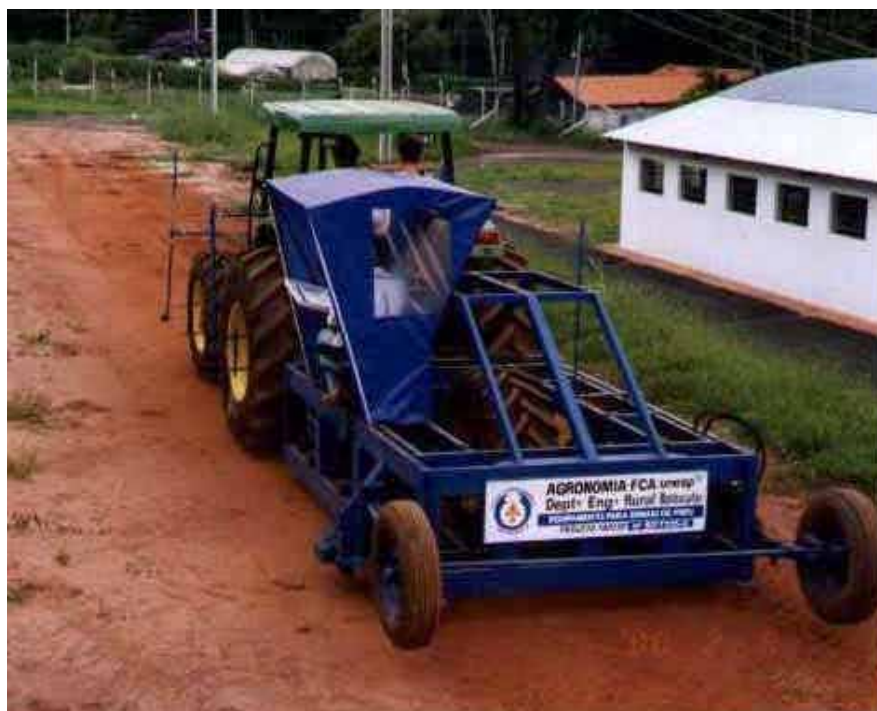
Figura 67. Equipamento realizando ensaio piloto em solo descoberto com pneu BPAF-1
