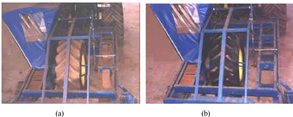
Figura 82. Pneu radial (a) e pneu diagonal (b) utilizados no experimento de campo
