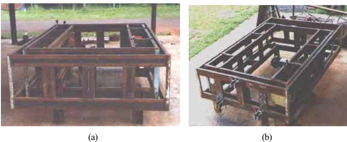
Figura 28. Vista traseira da montagem dos quadros internos e externos (a) e vista dianteira superior (b) do equipamento com os pontos de acoplamento
