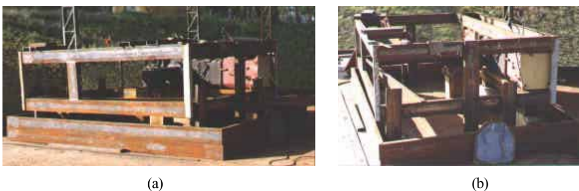
Figura 27. Vista lateral (a) e frontal (b) da construção dos quadros interno e externo do equipamento
