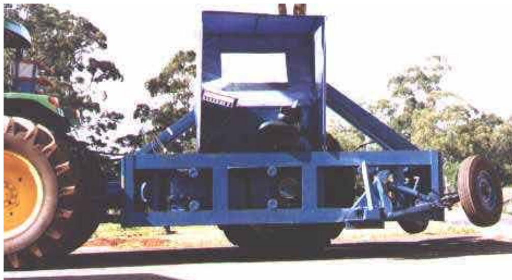
Figura 44. Posição de carga vertical máxima no rodado individual, com uma parte do peso apoiada no sistema hidráulico do trator e o restante no pneu.
