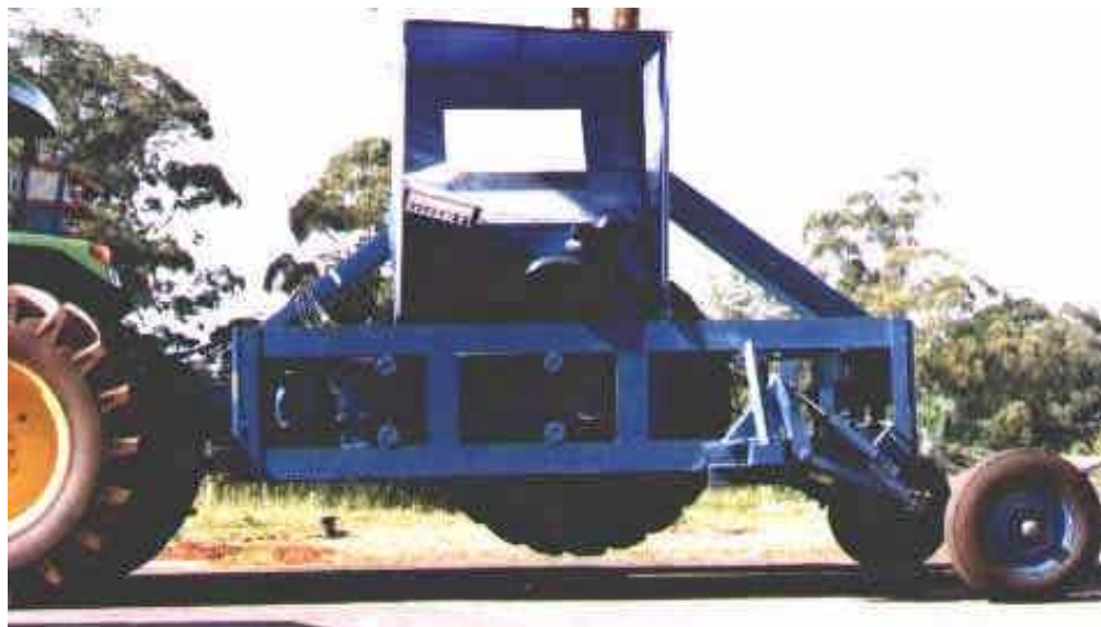
Figura 42. Levantamento em nível para transporte, testes da transmissão e/ou sensores e posicionamento para pesagem na balança.
