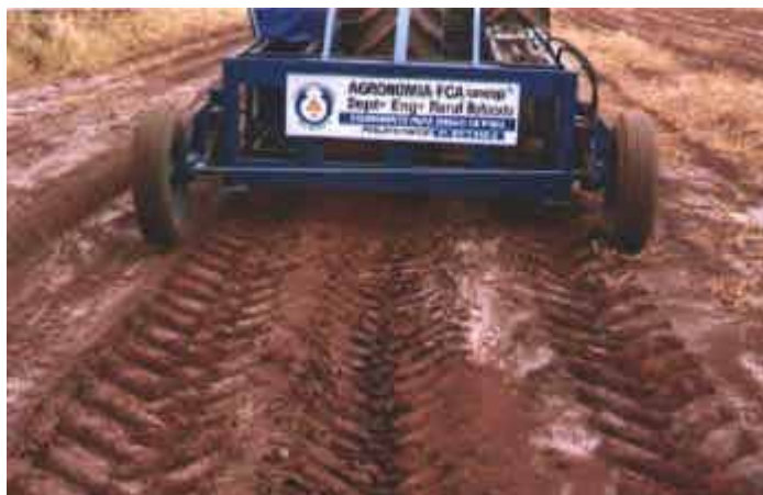
Figura 74. Rastro deixado pelo equipamento com patinagem alta (pneu BPAF-2)
