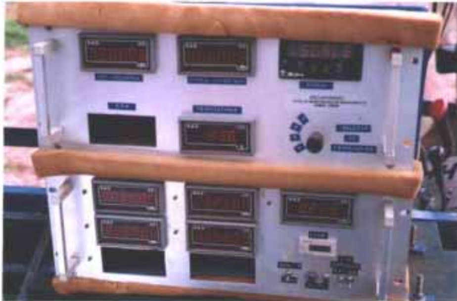
Figura 14. Painel 1 (em cima) e painel 2 (em baixo) utilizado nas calibrações dos sensores
