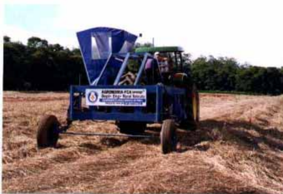
Figura 69. Ensaio piloto em solo coberto com palhada utilizando pneu BPAF-2
