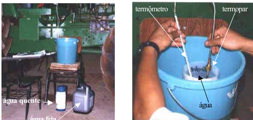
Figura 57. Calibração do sensor de temperatura utilizando água como fonte de calor
