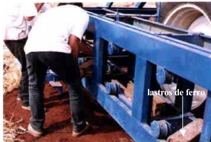
Figura 61. Colocação de lastros para ensaios do equipamento
