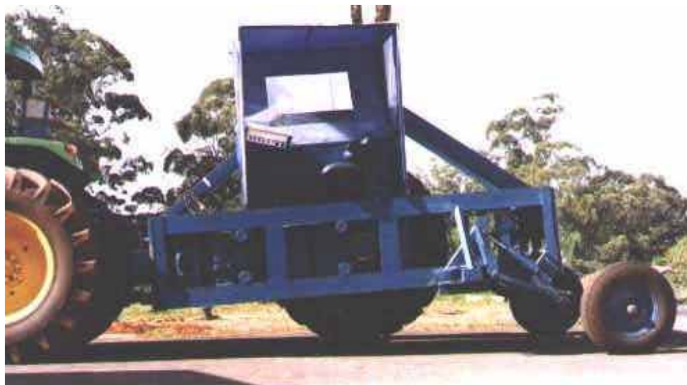
Figura 46. Levantamento das rodas de suspensão traseira pelo sistema hidráulico para eventual verificação do sistema de levantamento do equipamento.
