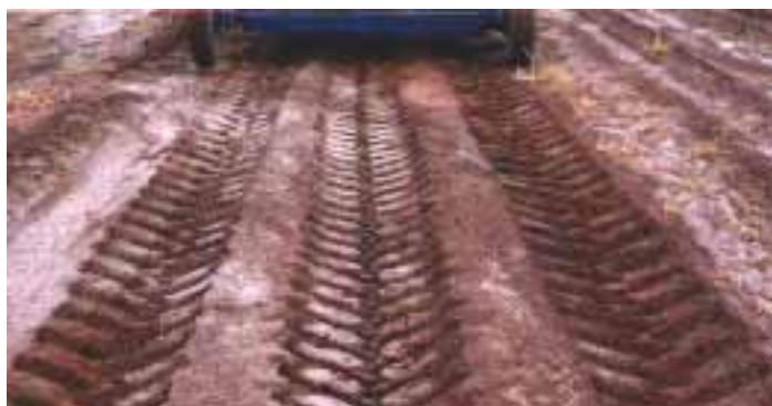
Figura 75. Rastro deixado pelo equipamento com patinagem baixa (pneu BPAF-2)
