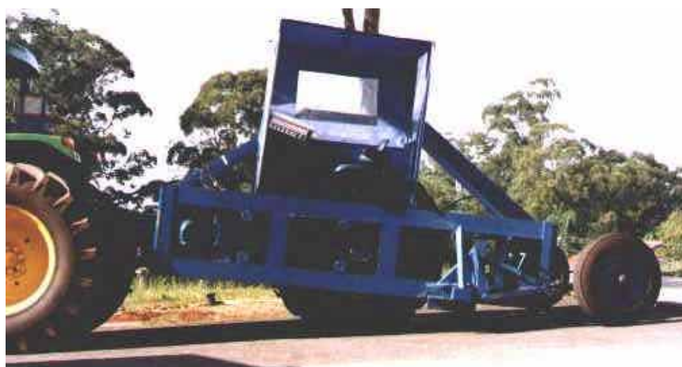
Figura 45. Levantamento dianteiro pelo sistema hidráulico do trator para eventual checagem do sistema de levantamento.
