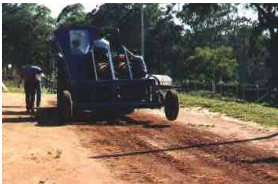
Figura 68. Ensaio piloto em solo descoberto com pneu BPAF-2
