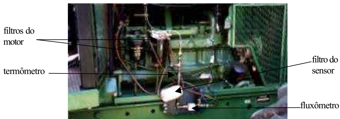
Figura 34. Instalação do medidor de temperatura e consumo de combustível no sistema de alimentação do trator
