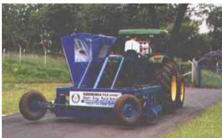
Figura 66. Ensaio piloto em superfície rígida com pneu BPAF-2
