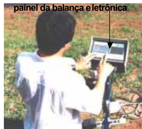
Figura 62. Nivelamento e instalação da balança para medição da carga vertical no rodado
