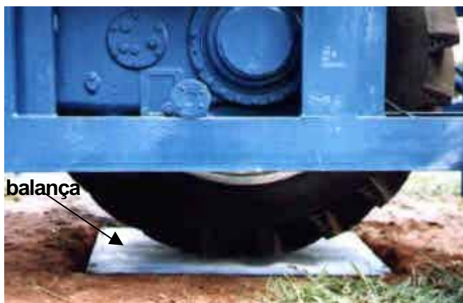
Figura 63. Pesagem da carga vertical no rodado do equipamento
