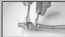
3. Coloque a porca do adaptador na entrada de gás. Em seguida, encaixe o adaptador e rosqueie a porca de fixação. Utilize duas chaves de boca para auxiliar o aperto.
