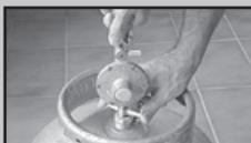
5. Após a instalação, verifique se há vazamento de gás, abrindo o regulador de pressão e colocando um pouco de espuma de sabão em todas as conexões que foram manuseadas. Se houver formação de bolhas, feche o registro do regulador e refaça a operação ou consulte a **Rede de Serviços Brastemp**.
