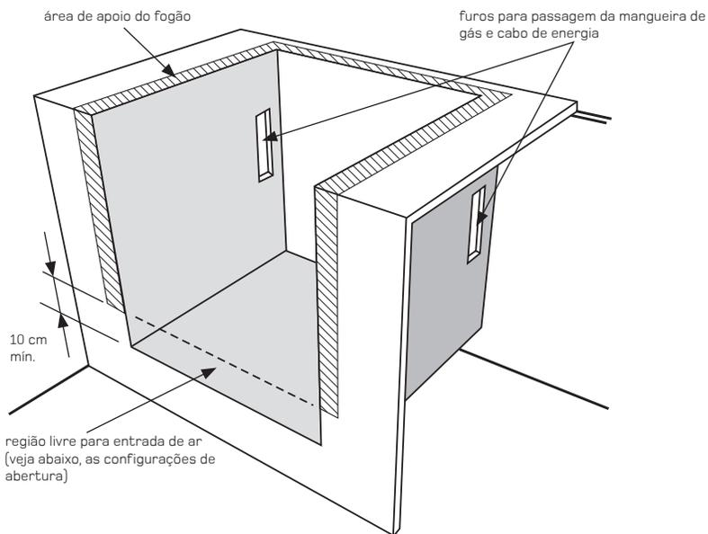
Os queimadores do forno necessitam de ar para seu correto funcionamento, portanto é necessário que o local de instalação proporcione aberturas na região inferior, verifique dentre as configurações de abertura de acordo com as figuras abaixo a melhor que se adapta ao seu móvel.
