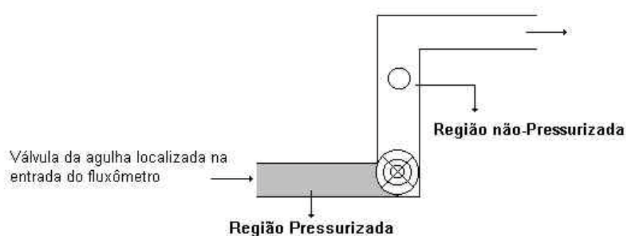
FIGURA 15 - Fluxômetro não-compensado a pressão
