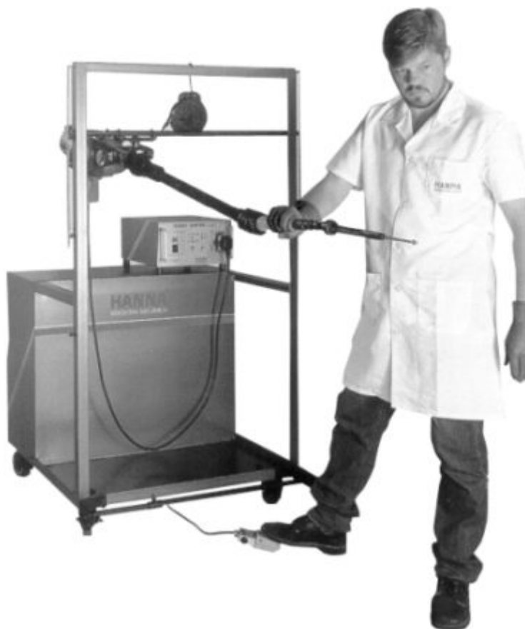
Eixo Telescópico Universal montado em Pórtico.
