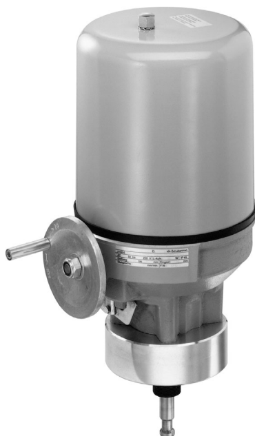
Fig. 1 - Tipo SAM -20 Actuador Linear, Curso nominal 30 mm, Força nominal 6 kN
