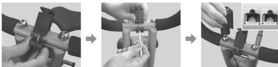
5. Instale o suporte do Display utilizando os parafusos, conforme mostrado nas figuras acima.
