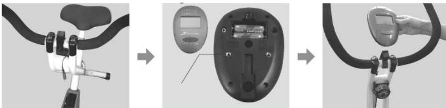
6. Instale 2 pilhas AAA no Display e encaixe o Display no Suporte. (Pilhas não inclusas)
