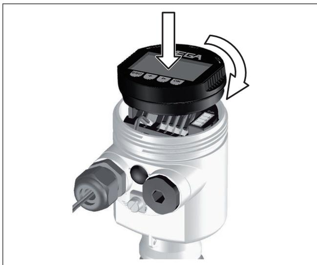
Fig. 20: Colocar o módulo de visualização e configuração
