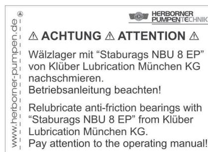
Figura 7 Autocolante Pós-lubrificação
