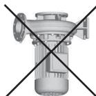
Não é permitida uma montagem da bomba com o "motor para baixo" por motivos de segurança em termos de funcionamento.
