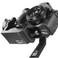
Ist der Gimbal in der vertikalen Achse korrekt balanciert, bleibt die Kamera in unterschiedlichen Winkeln in der entsprechenden Achse.
