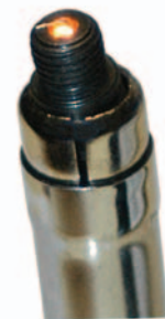
Cachimbo de vela com o filamento da vela ao rubro
