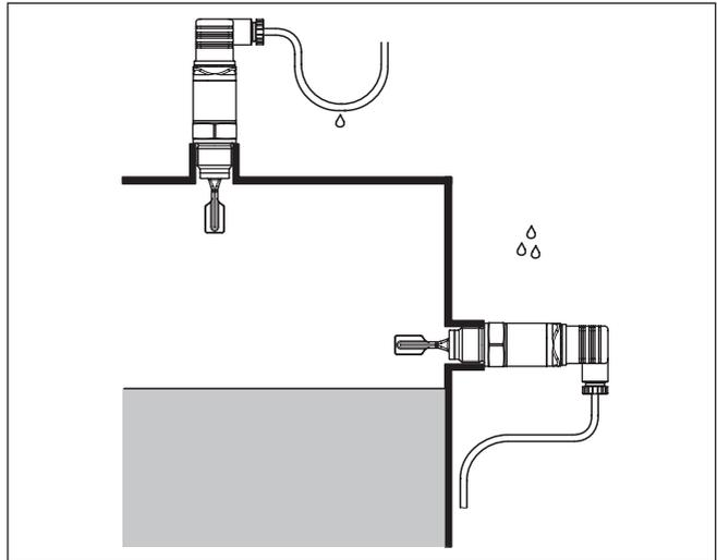
Fig. 4: Medidas para evitar a entrada de umidade
