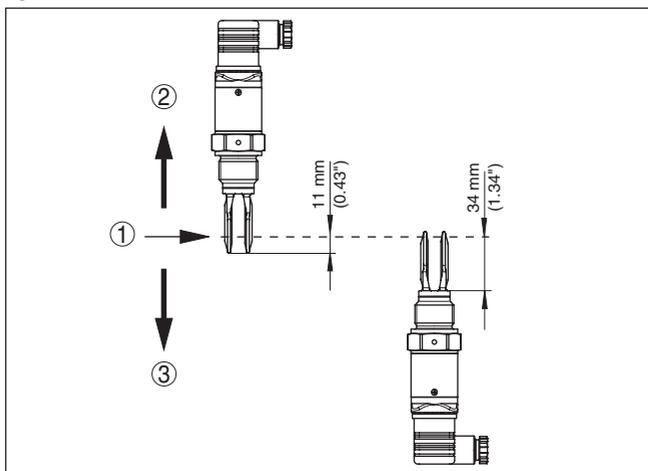
Fig. 2: Montagem vertical
