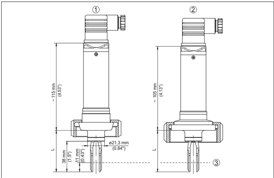
Fig. 35: SITRANS LVL100, modelos para alta temperatura
