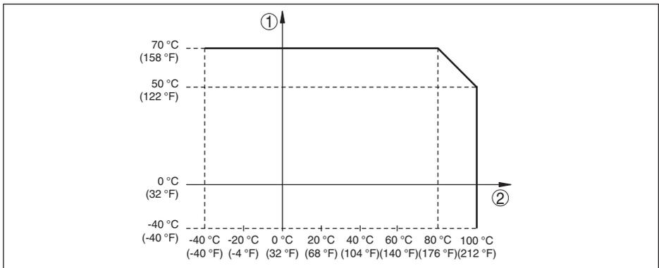
Fig. 30: Dependência da temperatura ambiente em relação à temperatura do processo
