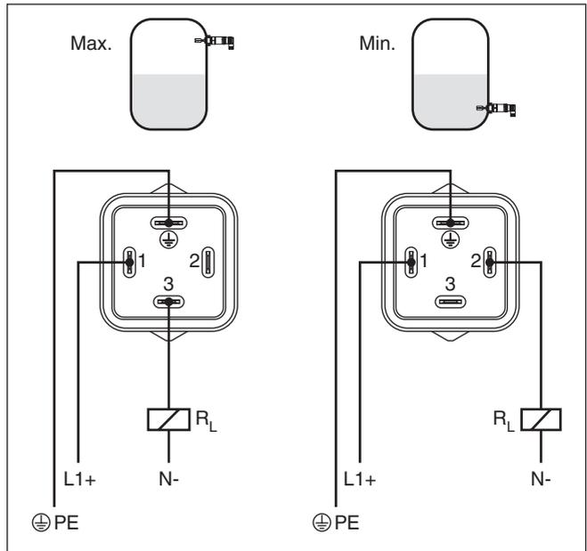
Fig. 10: Esquema de ligações, interruptor sem contato com conector de válvula ISO 4400
