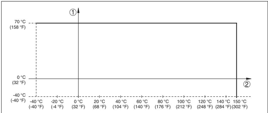
Fig. 31: Dependência da temperatura ambiente em relação à temperatura do processo
