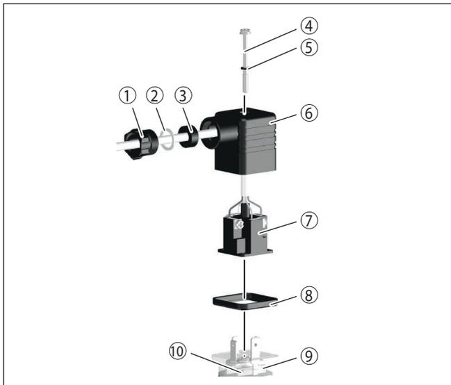
Fig. 8: Conexão conector de válvula ISO 4400
