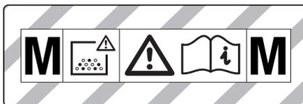
**AVISO:** Este aparelho contém pó perigoso para a saúde. O esvaziamento e a manutenção, inclusive a remoção do saco do pó só podem ser efectuados por uma pessoa especializada que usa equipamento de protecção pessoal adequado. Não ligar antes de instalar o filtro e de ter sido verificada a função do controlo da corrente volumétrica.
