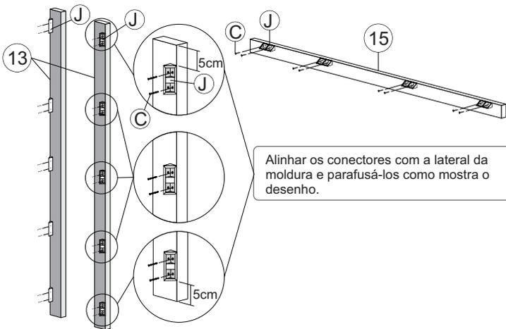
**10** Parafuse as vistas laterais (13) nas laterais do armário, utilizando conectores.
