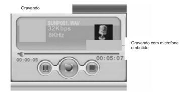
Use os botões "Esquerdo" ou "Direito" para selecionar entre a gravação com microfone embutido ou gravação com cabo de áudio.
