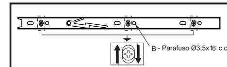
**Espaço livre na horizontal:** Retire a gaveta, desparafuse a corrediça na lateral do móvel, regule conforme a necessidade e parafuse novamente. Coloque novamente a gaveta no móvel, caso a folga esteja correta favor retirar a gaveta e aplicar mais (um) parafuso na corrediça, usando o furo fixo conforme desenho.
