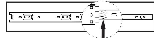
**PASSO 2:** Após fixo nas gavetas e nas laterais do móvel, encaixar a gaveta nas corrediças fixas nas laterais, empurrando-a.
