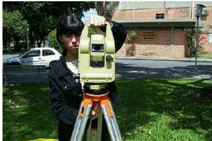
Figura 2.4 – Fixando o equipamento ao tripé
