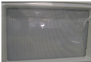
Figura 1.9 – Vista parcial da porta do forno onde é possível ver a grade metálica que impede o vazamento das microondas.
