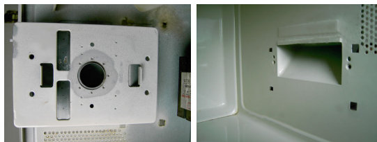
Figura 1.7 – a) A foto mostra o guia de ondas do lado externo do forno, onde o magnetron emite as microondas; b) mostra o guia de ondas na parte interna da câmara de cozimento com a tampa plástica retirada.
