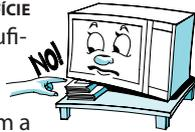
**COLOQUE O FORNO AFASTADO** de outras fontes de energia. Para possibilitar uma ventilação suficiente deverá haver uma distância de, pelo menos, 30 cm por cima do forno. Certifique-se de que o espaço por baixo, por cima e em redor do forno está vazio de modo a possibilitar um fluxo de ar adequado. Não coloque o forno microondas no interior de um armário.
