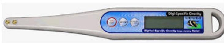
P: O que é exactamente um medidor específico de Gravidade/Salinidade Digital? R: O medidor DSG-10 é uma ferramenta 3-in-1 revolucionária que simplifica a medição dos 3 parâmetros mais importantes de um sistema de aquário de água salgada. 1. Temperatura (°C ou °F) 2. Salinidade (ppt) 3. Gravidade Específica P: Será que um hidrômetro barato, ou de vidro a flutuar contra as rochas é adequado?
