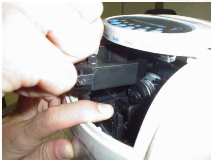
4 – Verifique se a fita ficou corretamente posicionada. Gire o recolhedor da fita para encaixar corretamente no cabeçote impressor e para remover qualquer impureza.
