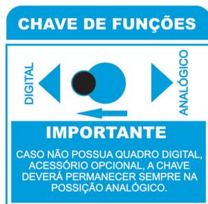
A chave de funções está instalada dentro do painel principal do trocador de calor, e tem a finalidade de definir com qual tipo de comando o equipamento irá atuar.
