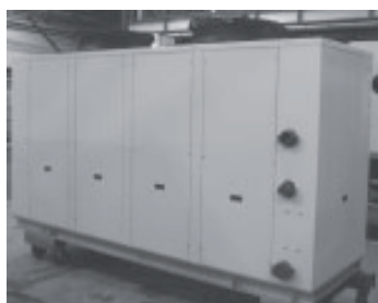
Painéis de serviço
