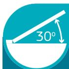
**Faça a instalação em dupla. Para encaixar as régua perfeitamente, comece posicionando a régua a ser instalada em um ângulo entre 20 e 30 graus. Você deverá pressionar toda a extensão lateral da régua.**
