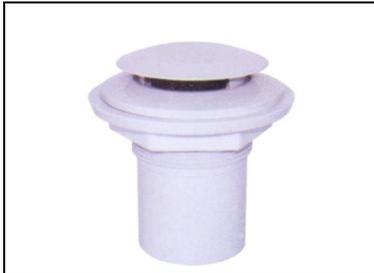
**RALO DE FUNDO** - Deve ser conectado à tubulação de sucção da bomba hidráulica. A água que flui através do dreno arrasta toda a sujeira que tende a se depositar na parte mais profunda do tanque. Ele também permite a drenagem total da piscina para fins de manutenção.
