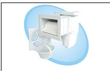
**COADEIRA** - A coadeira é instalada na parede do tanque na altura do nível da água e conectada à sucção da bomba. Sua função é promover um fluxo superficial da água da piscina e assim recolher as partículas flutuantes, tais como folhas, insetos, óleo etc.
