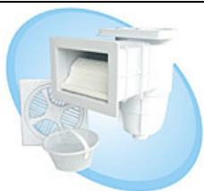
**COADEIRA** - A Coadeira é instalada no sentido contrário do Retorno, na parede do tanque na altura do nível da água e conectada à sucção da bomba. Sua função é promover um fluxo superficial da água da piscina e assim recolher as partículas flutuantes, tais como folhas, insetos, óleo etc.
