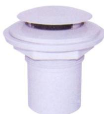
**RALO DE FUNDO** - Deve ser **instalado na parede com 10cm do fundo da Piscina**. Conectado à tubulação de sucção da bomba hidráulica. A água que flui através do dreno arrasta toda a sujeira que tende a se depositar na parte mais profunda do tanque. Ele também permite a drenagem total da piscina para fins de manutenção.
