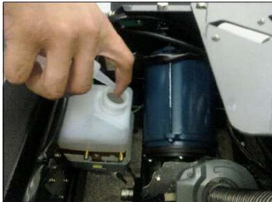
*Fig.20 Reservatório de silicone.*
