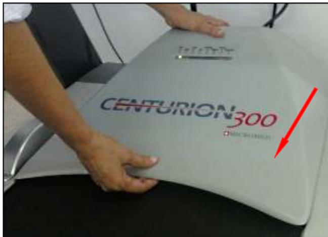
*Fig.18 Tampa de proteção do motor.*
