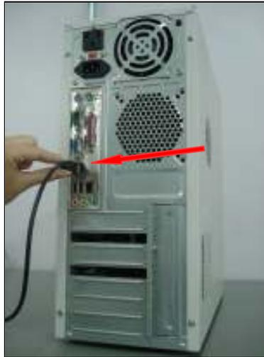
*Fig.7 Conexão do cabo USB no microcomputador.*
