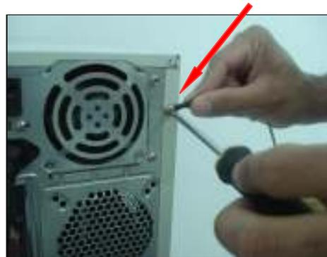
*Fig.9 Fixação do cabo de aterramento.*
