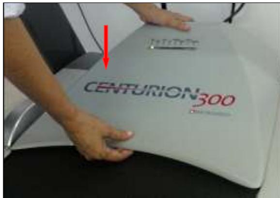
*Fig.22 Fixação da tampa de proteção do motor.*
