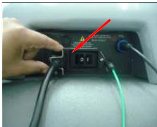
*Fig. 12 Trava do cabo de alimentação.*
