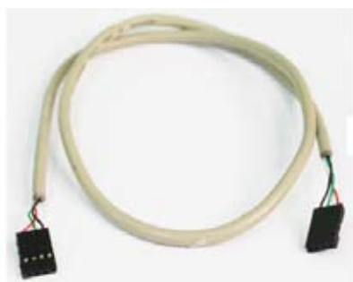
Fig. 19: Cabo de ligação entre o GAM 110 e o Módulo de Captura Dupla.
