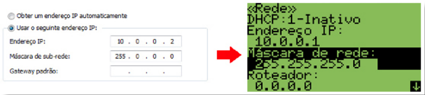
Fig.34 - Exemplo de entrada de parâmetros de IP e máscara de rede em redes do tipo 10.X.Y.Z
