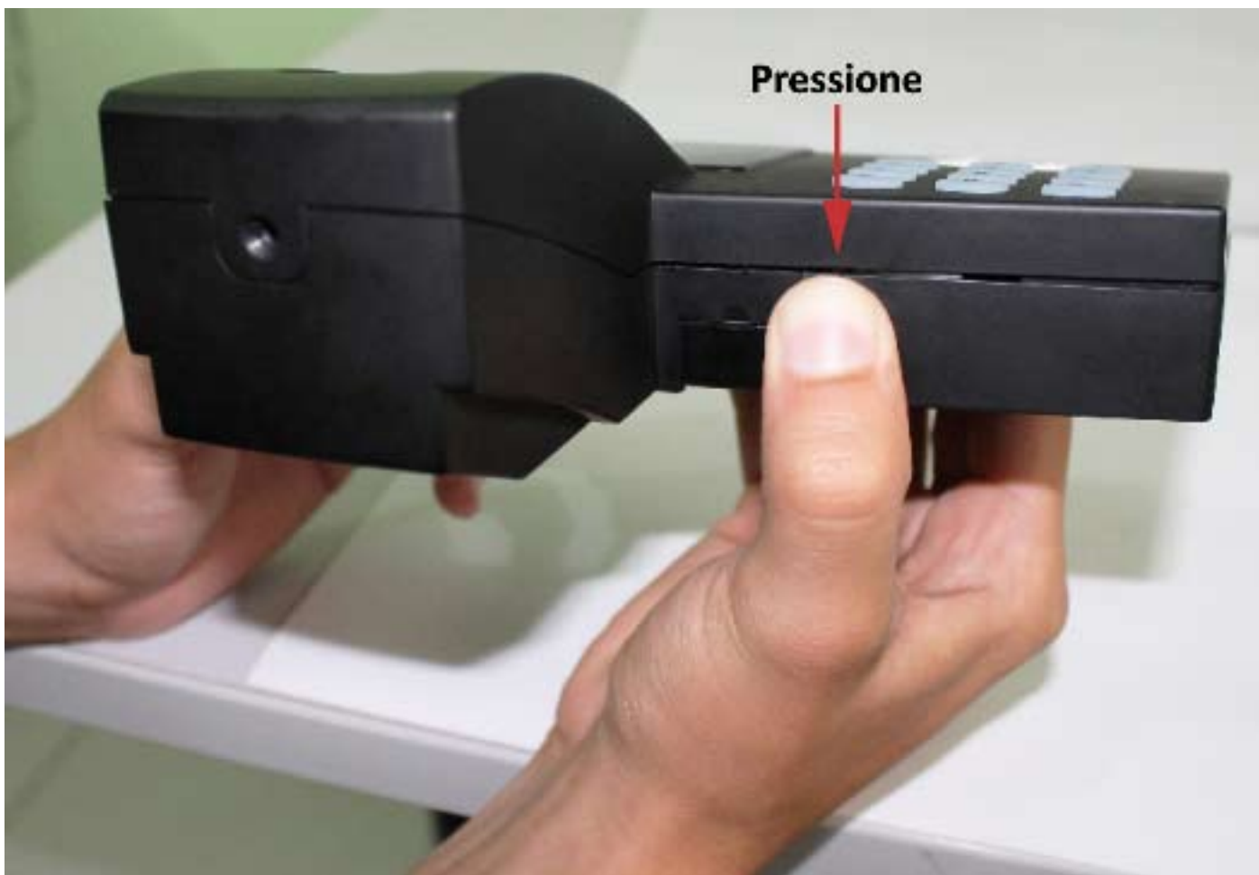
Fig. 10: Exerça pressão sobre o local indicado pelo dedo polegar na figura, após a remoção do parafuso de fixação
