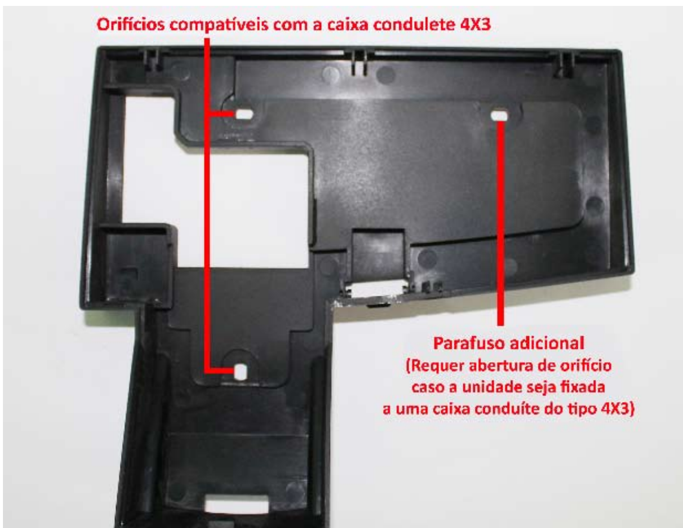
Fig. 18: Locais para os parafusos de fixação no painel posterior do GAM 110. A unidade pode ser fixada a uma caixa condutele do tipo 4X3 com parafusos/buchas de 6 milímetros. Para fixação da unidade em uma placa acrílica, utilize parafusos de 4mm.
