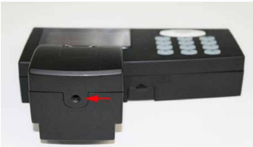
Fig. 3: Local de fixação do parafuso na parte inferior do GAM 110.
