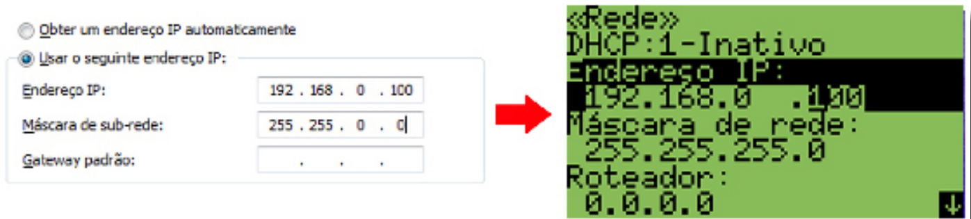
Fig.33 - Entrada dos parâmetros de endereço de IP e máscara de rede em em redes do tipo 192.168.X.Y: correspondência entre o computador e o GAM 110.
