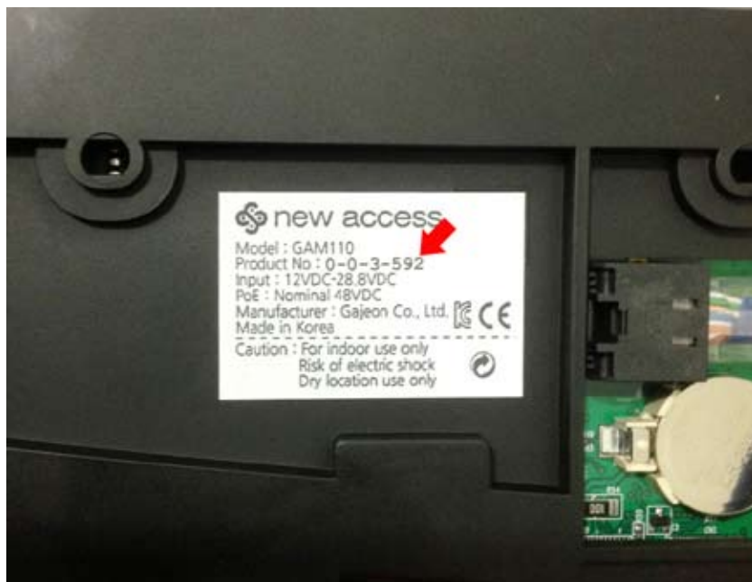
Fig. 36 - Se vários dispositivos diferentes estiverem disponíveis na lista, o número na etiqueta no painel traseiro do GAM 110 pode ser usado para auxiliar na identificação. O número disponível na etiqueta...
