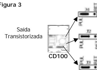
**Atenção:** É muito importante verificar os posicionamentos dos jumper's para o tipo de acionamento desejado.
